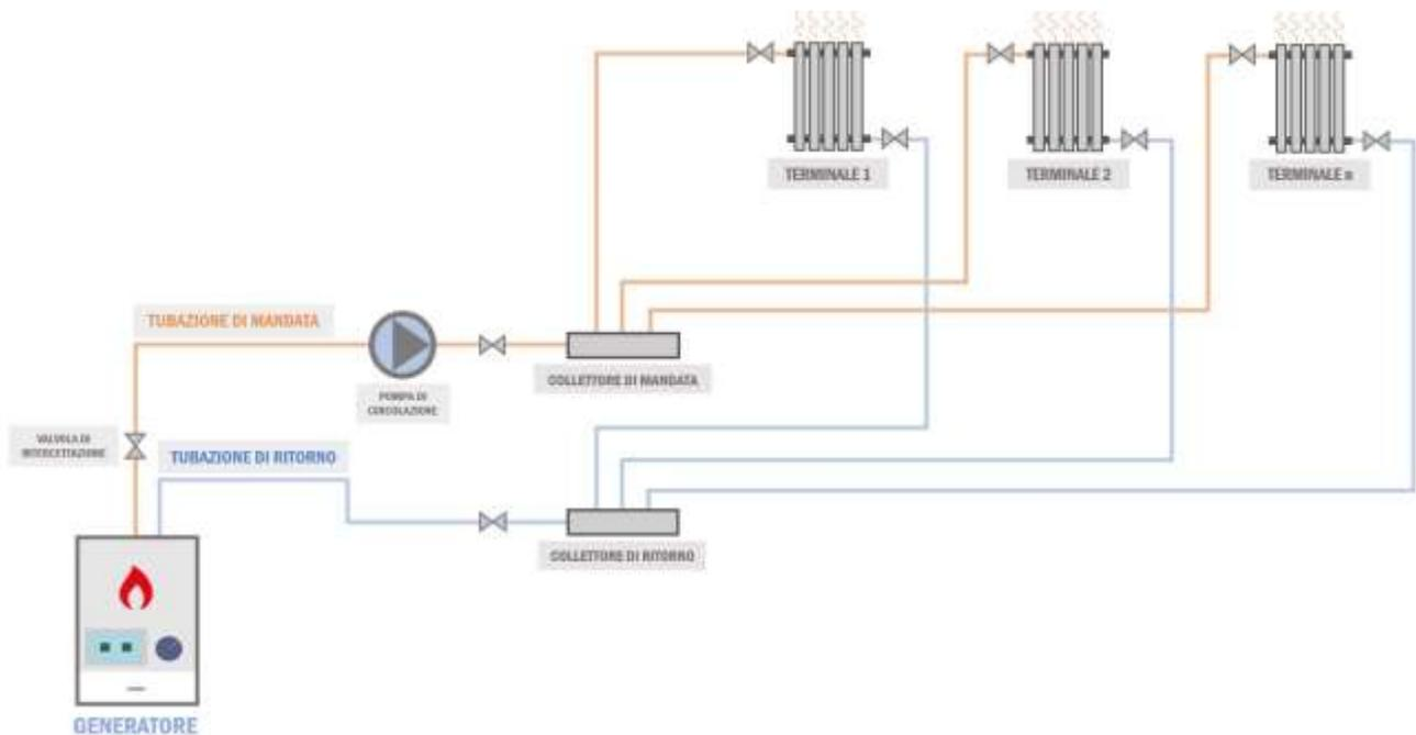
Nel caso di impianto autonomo, abitazione singola, il numero di collettori da predisporre sarà funzione della superficie calpestabile. Per gli impianti centralizzati invece, è previsto un collettore al servizio di ciascun appartamento. Le tubazioni vanno solitamente posizionate sotto pavimentato e devono pertanto essere coibentate al fine di mantenere stabile la temperatura del fluido all'interno.
